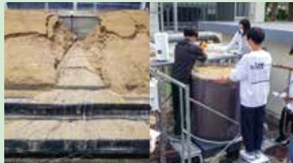
降雨による斜面の崩壊
