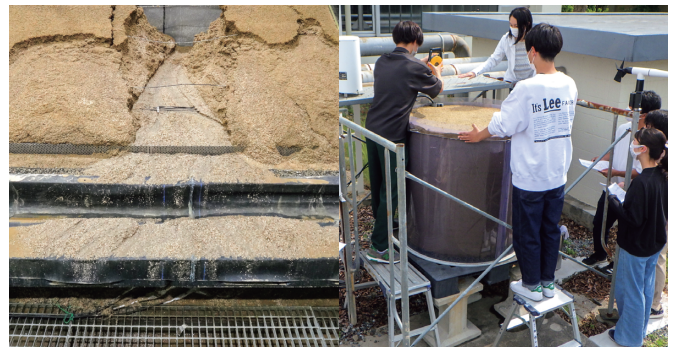
降雨による斜面の崩壊
